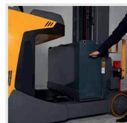
BATTERIE EXTRACTIBLE SUR LE CÔTÉ, PERMETTANT UN REMPLACEMENT SIMPLE POUR FACILITER LA MAINTENANCE DU CHARIOT ÉLÉVATEUR
